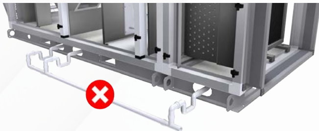
Nieprawidłowe wykonanie instalacji odprowadzenia skroplin.
