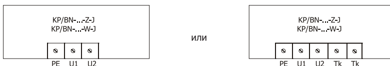
Рис. 1. Схема подключения завес: KP/BN-...-[-W;-Z;-J]
