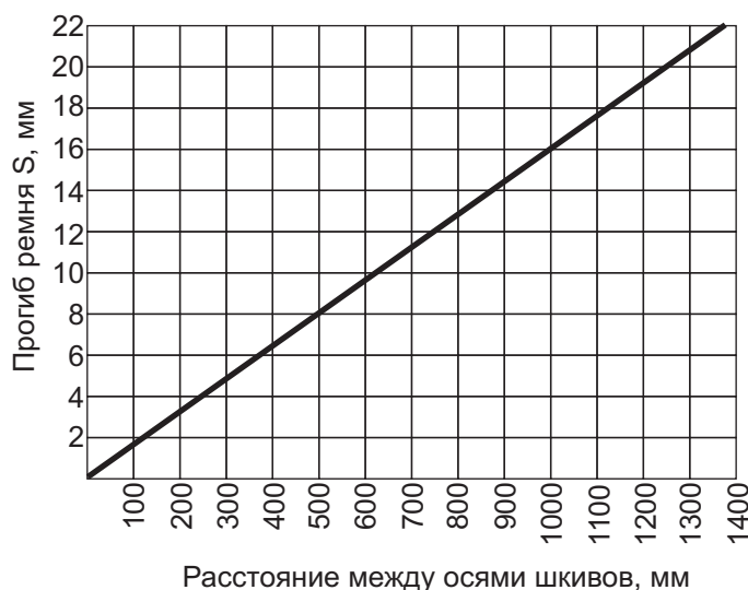
Рис. Прогиб клинового ремня в зависимости от расстояния между шкивами.
