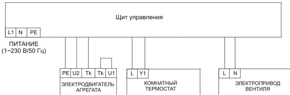
Рис. 5. Схема электроподключений автоматики агрегата без регулятора ARW
