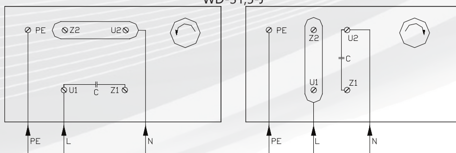
Tabliczka podłączenia silnika: OWD-...-J
